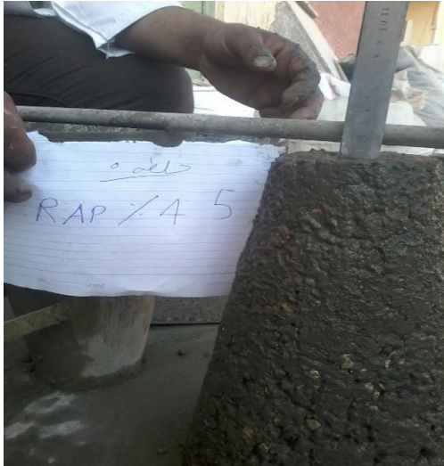
Fig. (6) Slump cone test
